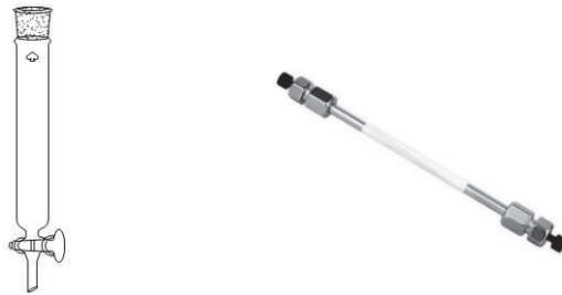
รูปที่ 5-4 ตัวอย่างคอลัมน์แก้ว (ซ้าย) และ คอลัมน์โลหะ (ขวา)
